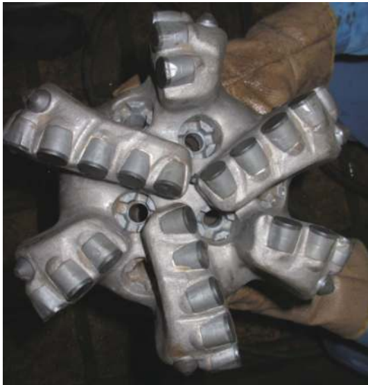
图 6 专用 PDC 钻头出井照片
