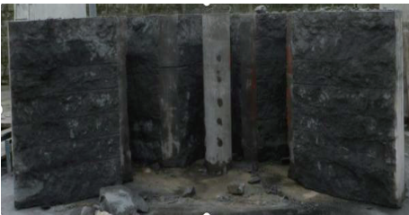
图 7 射孔后的混凝土靶
