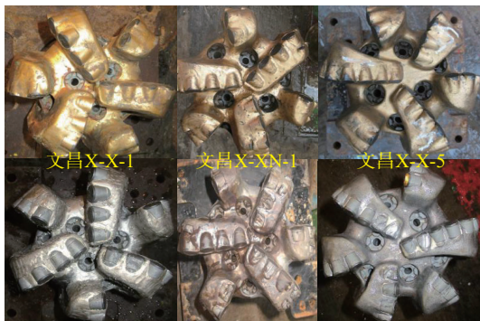
图 4 三口井 PDC 钻头使用前后对比
