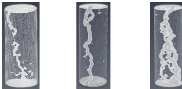
(a) 注酸速度为0.5 mL/min (b) 注酸速度为1.0 mL/min (c) 注酸速度为2.0 mL/min b. 胶凝酸
