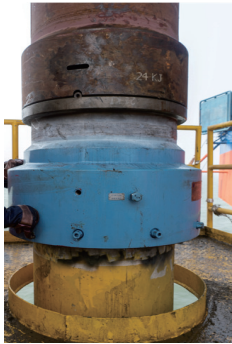
图 6 新型隔水管快装井口装置应用图
