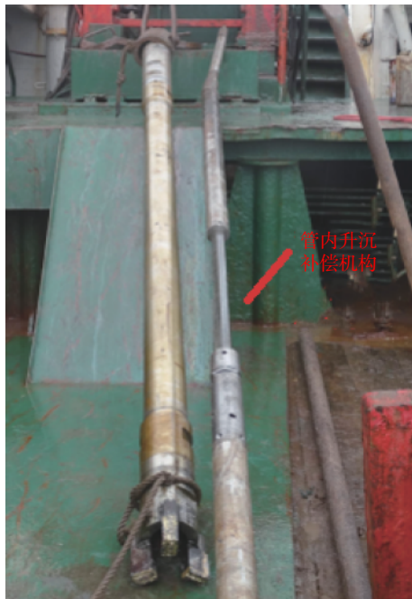
图 2 取心器内部平衡波浪升沉机构示意图
